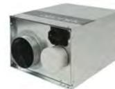
Caisson d'extraction en ligne - piquages d125 en ligne - moteur ac basse consommation 230 v - interrupteur de proximité - débit jusqu'à 250 m3/h
