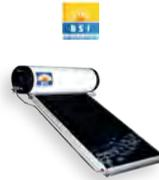
Ballon en acier inoxydable 316L, isolation mousse polyuréthane 50 mm, tôle galvanisée pré-laquée avec protection film plastique. Capteur K716 & 720-TS 15/22. Support Toiture inclinée visserie inox A4-70. Kit hydraulique comprenant : Groupe de Sécurité - Joints en fibre - Mamelons G3/4 & 3/4-7/8 - Bouchons laiton G7/8 M STBI087 - Vis, écrous, rondelles inox.
