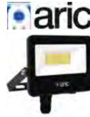
Proj. Ext. IP65 IK08, noir, LED 110° 10W 3/4000K 1050lm, connecteur IP68 prémonté. Proj. Ext. IP65 IK08, noir, LED 110° 30W 3/4000K 3000lm, connecteur IP68 prémonté. Proj. Ext. IP65 IK08, noir, LED 110° 50W 3/4000K 5500lm, connecteur IP68 prémonté
