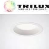
Spot encastré à LED. Découpe dans le plafond Ø 180 - 195 mm. Profondeur d'encastrement ≥ 97 mm. Avec diffuseur fermé en PMMA, à prismes. Réflecteur, laqué blanc. À répartition intensive-extensive symétrique en rotation des intensités
