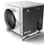
Moteur EC très basse consommation 230 V (50/60 Hz) Télécommande simple et intuitive toujours à portée de main grâce à son câble et sa fixation magnétique. 2 modes possibles de pilotage : pression constante pour minimiser la consommation ou par sonde externe 0-10V. Renvoi d'alarme disponible par câblage sur la carte électronique. Option Modbus R485 et AldesConnect™ Pro.
