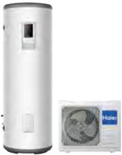
Thermopompe avec unité extérieure déportée, à poser au sol. Classe énergétique A+. Installation intérieure du ballon. Capacité de stockage 195 - 293 litres. Échangeur microcanal en aluminium et titane pour une plus grande surface d'échange, et une spirale supplémentaire placée au fond de la cuve, le tout entraînant un échange supérieur de 30%. Réservoir en acier émaillé au titane, anode de magnésium, isolation en mousse polyuréthane de 50 mm.
