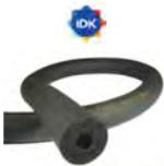
Manchons isolant M1 en longueur de 2 mètres, épaisseur 13 ou 19mm. Température d'utilisation : -50°C à +105°C. Coef. conductivité thermique :  $\lambda$  0°C  $\leq$  0,034 W/(m.K) $\mu$ . Résistance au feu : m1 ou Euroclasse B-s3, d0.
