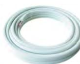
Bi-tube Couronnes de 20 m. Isolant en mousse à base de polyéthylène réticulé à cellules fermées. Température d'utilisation : de. 80°C à + 120°C. Conductivité thermique à 0°C ≤ 0.037 W/m²K. Film protecteur traité anti-Uv et anti-arrachement. Aspect extérieur blanc. Epaisseur minimale garantie => 1/4 à 1/2" = 0,8 mm - 5/8" = 1 mm.
