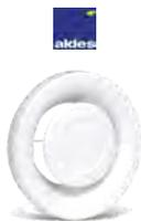
Bouche de reprise SR 143 D100 à 200 mm. Acier avec peinture époxy blanc RAL9010 30%. Débit réglable grâce au noyau blocable par contre-écrou. Anneau extérieur avec joint d'étanchéité. Montage mural/plafond. Manchette raccordement acier fournie.
