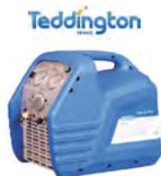
Mini stations de récupération TF-VRR12L-R32 & TF-VRR24L-R32 tous fluides. Une seule manipulation, facile à utiliser Equipée d'un séparateur d'huile et d'une protection haute pression; Compresseur 3/4 & 1 cv à piston à sec Fonction auto-purge. Capacité de récupération maximum en Kg/min: Vapeur = 0,26 / 0,50. Liquide = 2,20 / 3,50. Push/Pull = 6,30 / 9,50. Poids 14,2 / 14,7 kg. Conforme à la norme NFE35421.
