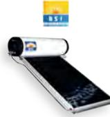
Ballon en acier émaillé, isolation mousse polyuréthane 50 mm, tôle galvanisée pré-laquée avec protection film plastique. Capteur K716 & 720-TS 15/22. Support Toiture inclinée visserie inox A4-70. Kit hydraulique comprenant : Groupe de Sécurité - Joints en fibre - Mamelons G3/4 & 3/4-7/8 - Bouchons laiton G7/8 M STBI087 - Vis, écrous, rondelles inox.
